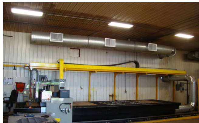
Beispiel für einen Trockenabsaugtisch: Die Verunreinigungen werden in einen Trockenabscheider im Freien abgesaugt, der Staub und Dämpfe auffängt.
