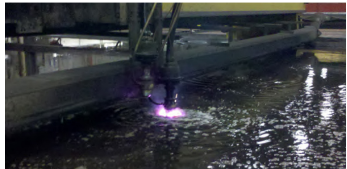
Beim Plasmaschneiden auf einem Wasserbett-Werkbank entsteht eine schmutzige, wartungsintensive Umgebung.
