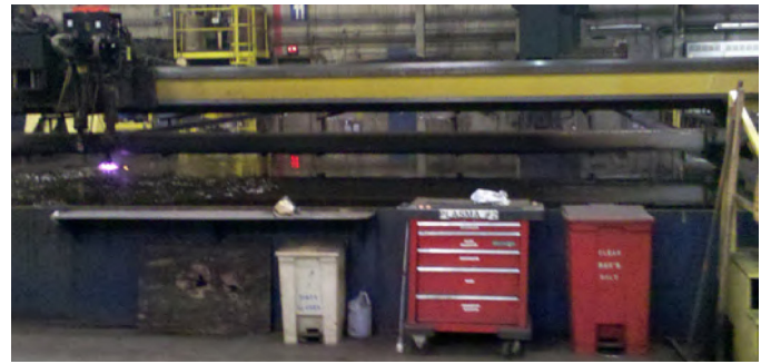
Beispiel einer Wasserbett-Werkbank, die so konstruiert ist, dass der größte Teil des Staubs und der Dämpfe beim Schneiden der Werkstücke im Wasser zurückgehalten wird.
