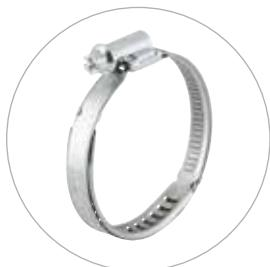
Ve srovnání se standardními šnekovými sponami je radiální vložka pružinovou sponou s optimálními kontrakčními a expanzními možnostmi. Je ideální pro aplikace, kde jsou hadice vystaveny teplotním výkyvům. Speciální design zajišťuje spolehlivé utěsnění po celou dobu tepelného cyklu. Dostupné pro TORRO® spony v šířce pásku 9mm.
