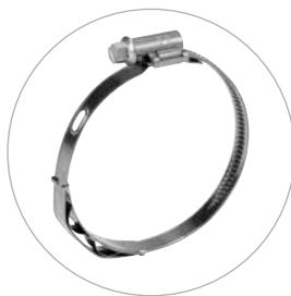
**LOCH** - otvor je užitečný prostředek pro předupevnění hadicové spony TORRO® na hadici. V tomto případě nachází oválný otvor v objímce přesný protikus na ploše hadice. Spona TORRO® je proto bezpečně a přesně fixována na místě před konečnou montáží. Dostupné v šířce pásku 9 a 12 mm, umístění otvoru na přání.
