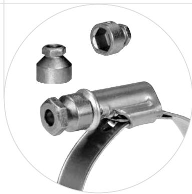
Momentová pojistka se při dosažení předepsaného utahovacího momentu ukroutí, takže není nutné používat momentový klíč. Drážka šroubu je přístupná i po ukroucení, je tedy možné sponu v případě potřeby demontovat nebo dotáhnout.
