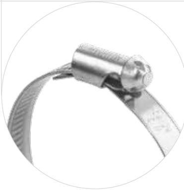
Montáž a demontáž hadicové spony NORMACLAMP® TORRO® Tamperproof lze provádět pouze za použití bezpečnostního šroubováku (podrobnosti na straně 199). Speciálně konstruovaná hlava šroubu má tři radiální drážky, které neumožňují použití na trhu dostupných nástrojů. Automatizovaná instalace pomocí momentového utahováku je velmi efektivní, protože speciální tvar hlavy šroubu umožňuje minimální vyosení nebo posun.
