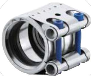
**NORMACONNECT® FLEX E** je axiální spojka bez zajišťujícího účinku, která se používá ke spojení a utěsnění nerezových trubek a rovněž betonových a plastových trubek. Toto je verze s dutými čepy.
