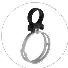
Předotevřená verze zajištěná plastovým klipem, kterou lze také přilepit na hadici. Informace o přilepení vám poskytne váš obchodní zástupce. Po nasazení spony na hadici se tento klip snadno odstraní rukou.
