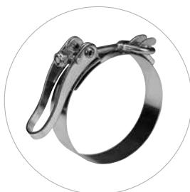
Uzávěr spony NORMACLAMP® SVS lze také osadit šroubem s okem. To je užitečné v případě, kdy se instalace provádí v rukavicích. Na přání dodáváme šířky pásku 15, 20 a 25 mm.
