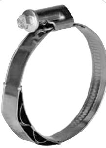
Spona TORRO® WF obsahuje vlnovou pružinu, která automaticky upravuje své napětí v zájmu zajištění optimální radiální upínací síly. TORRO® WF je ideální volbou pro aplikace s velkými teplotními výkyvy (např. stlačený vzduch), s extrémně nízkými teplotami nebo pro zajištění hadic s tendencí smršťování/relaxace.
